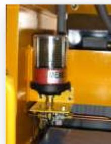
**Dispositif de graissage centralisé**
